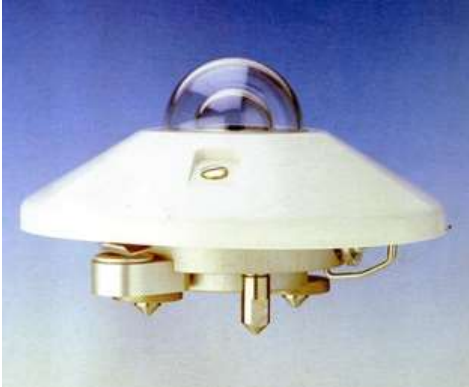
Figura 1. Piranómetros termoeléctricos utilizados por el SMN
