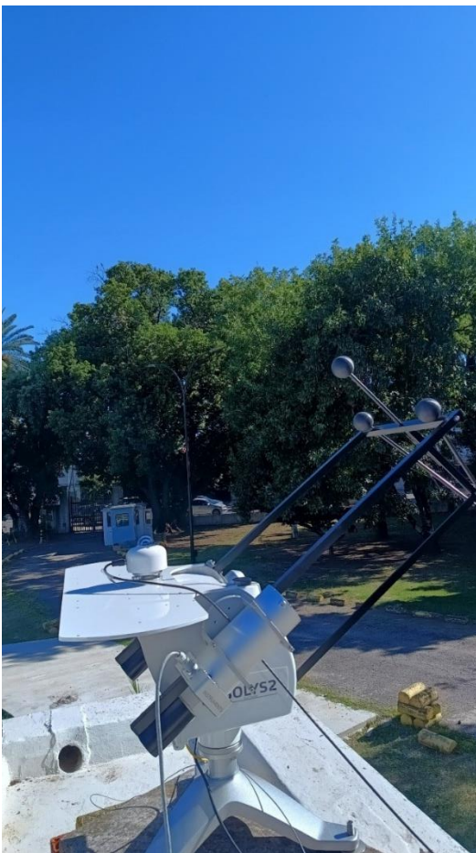
Fig. 4. Seguidor solar a dos ejes en el cual se montó el PMO8 (para medición de la DNI) y el piranómetro SR30_18181 (para la medición de la DHI), incluyendo el accesorio de sombreado.
