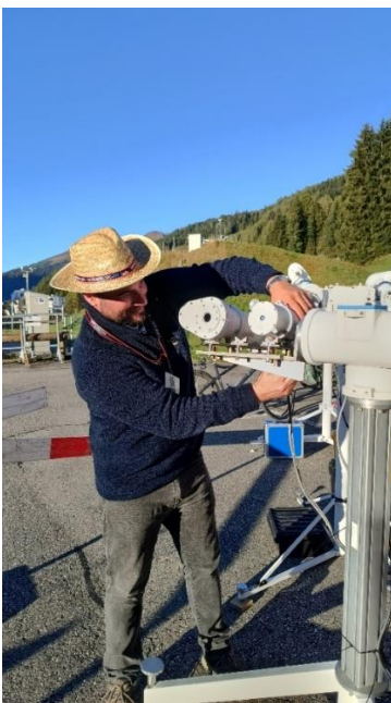
Fig. 1. Montaje del PMO8 en el seguidor solar durante el IPC XIV en Davos.
