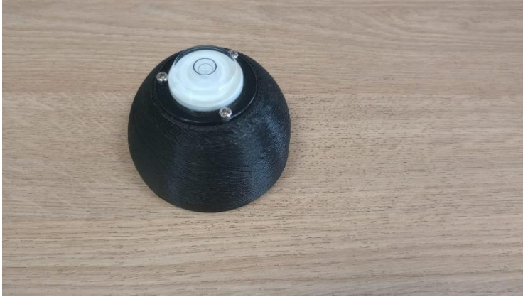
Fig. 3. Nivel externo utilizado para nivelar piranómetros que no contaban con burbuja.
