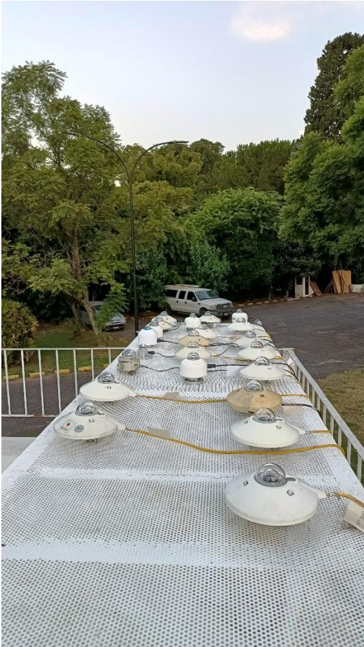
Fig. 2. Mesada utilizada para las calibraciones de radiómetros solares en Buenos Aires. La imagen muestra algunos de los piranómetros que participaron de la campaña. La plataforma está alineada según un eje Este-Oeste, con el Norte orientado hacia la parte izquierda de la imagen
