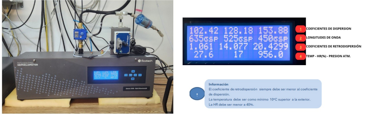
Figura 1: Vista frontal del instrumento Nephelometer AURORA3000
