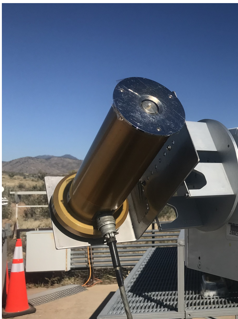
Figura 12: Pirheliómetro TMI MK VI, en la intercomparación NPC-2022. El instrumento se encuentra montado sobre un seguidor solar Kipp & Zonen Solys, y al momento de la fotografía se encontraba tapado (registro de offset).
