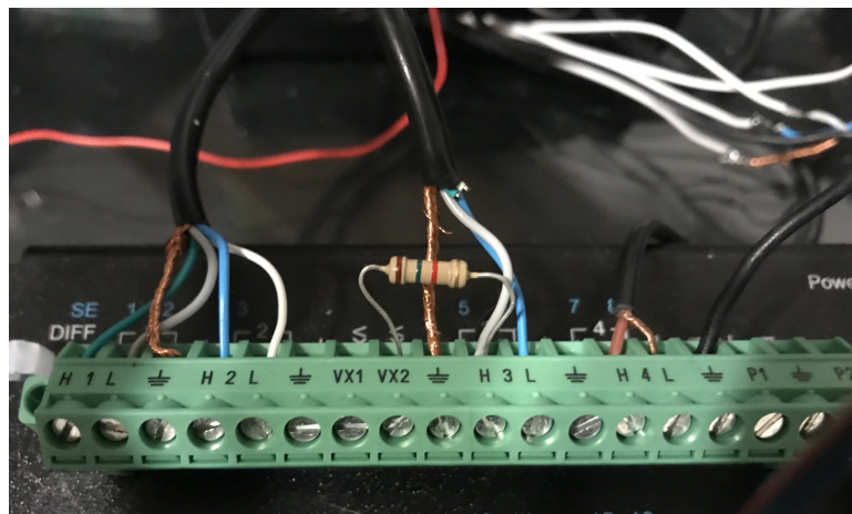
Figura 6: Conexión de los cables salientes de la caja de interconexión a la bornera del adquisidor de datos CR1000X. De izquierda a derecha: Diff1: Tensión en resistencia calefactora (V R10)(H - verde, L - gris, malla - tierra) Diff2: Corriente en resistencia calefactora (V R11)(H - azul, L - blanco). VX2: Excitación para medición de termistor, a resistencia de 1500. Malla a tierra. SE5(Diff3) a cable blanco de termistor y resistencia de 1500Ω. SE6(Diff3) a cable azul de termistor. Diff4: Termopila (H - marrón, L - malla) Cable negro independiente - tierra para capacitores.
