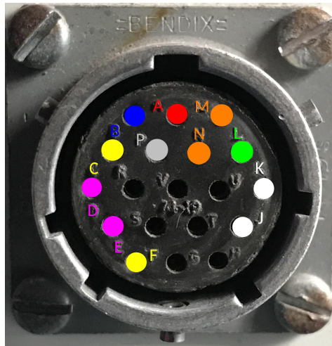
Figura 7: Vista del conector Bendix de 19 vías (ficha hembra, ubicada en el sensor MK VI y en la caja de interconexión). A(+) y B(-): Termopila. C(+) y F(Gnd): Alimentación de resistencia calefactora (5Vdc). D(+) y E(-): Medición de tensión aplicada sobre resistencia calefactora. J y K: Calefactor de unidad (no utilizado). L(Gnd), M y N: Termistor. P: Gnd (no utilizado)
