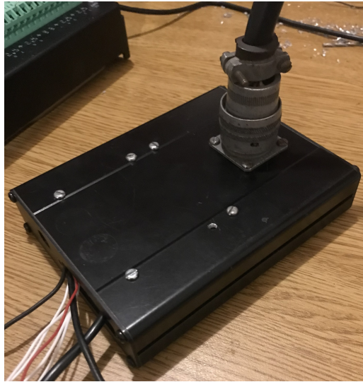
Figura 5: Esta caja contiene las resistencias R9, R10, R11 y R12. La función de este nuevo elemento es permitir la conexión de la unidad MK VI (a través de su cable) al adquisidor de datos CR1000X. De esta caja sale un cable de cuatro conductores más malla (alimentación y medición de la resistencia calefactora), un cable de dos conductores y malla (medición del termistor), un cable coaxial (termopila), un cable simple de color negro (tierra para capacitores de la termopila) y un cable simple rojo (alimentación de 5V para la resistencia calefactora, debe conectarse a una salida de 5V de la bornera de la unidad CR1000X 1 , con capacidad para entregar al menos 25mA).
