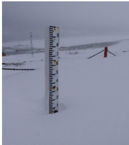
Figura 2: Regla nivométrica fija. Foto Vanesa Arzac. Estación Esperanza.
