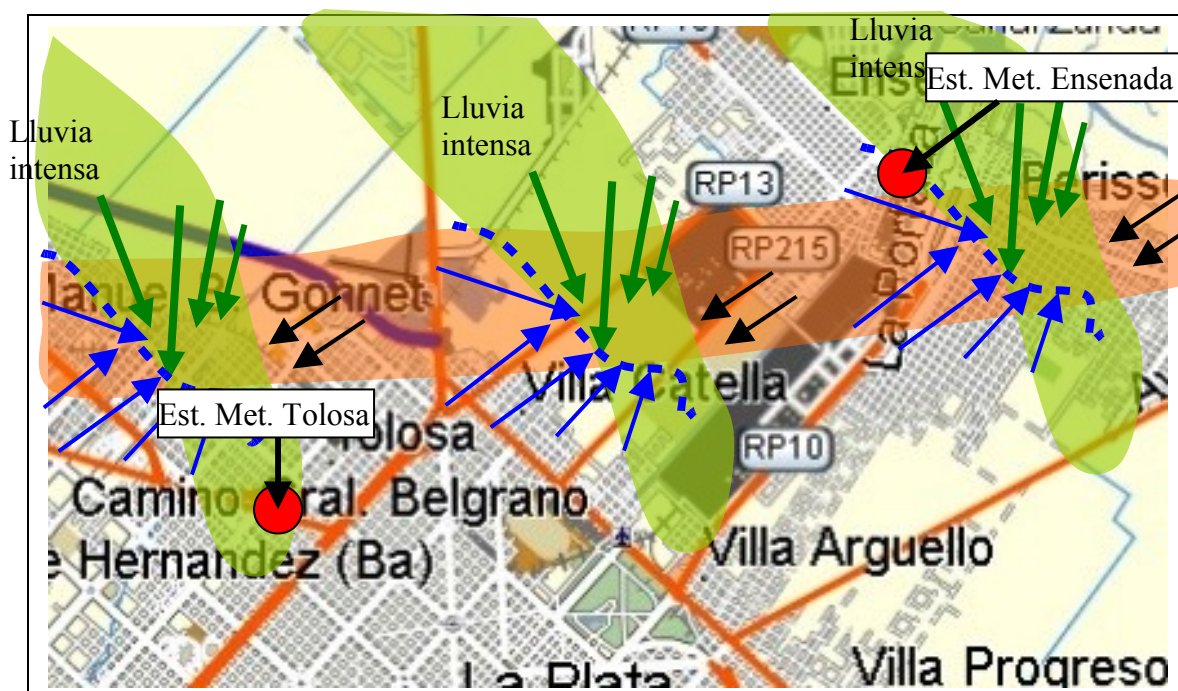
Figura 16: Esquema del fenómeno de viento que produjo los daños a lo largo de su traslado desde Gonnet hacia Berisso. Los círculos rojos indican la ubicación de las estaciones meteorológicas y la franja anaranjada la zona con daños severos.
