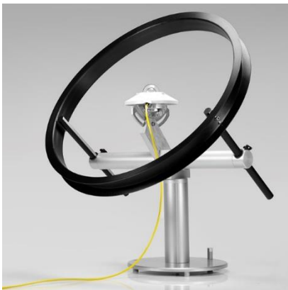
Figura 2. Aro sombreador que proyecta sombra sobre el sensor para medir radiación difusa. Fuente https://www.kippzonen.com/
