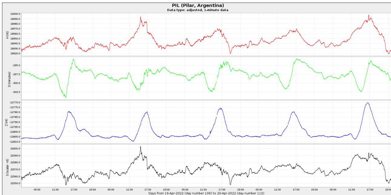
**Figura 4b:** Componentes del campo magnético del 11 al 20 de abril. En rojo se ve la componente horizontal ( $H$ ) y en azul la vertical ( $Z$ ), ambas en nT. En verde se presenta la declinación del campo magnético ( $D$ ) en minutos y en negro la intensidad del campo magnético en nT.
