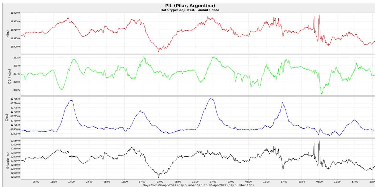
**Figura 4a:** Componentes del campo magnético del día 1 al 10 de abril. En rojo se ve la componente horizontal ( $H$ ) y en azul la vertical ( $Z$ ), ambas en nT. En verde se presenta la declinación del campo magnético ( $D$ ) en minutos y en negro la intensidad del campo magnético en nT
