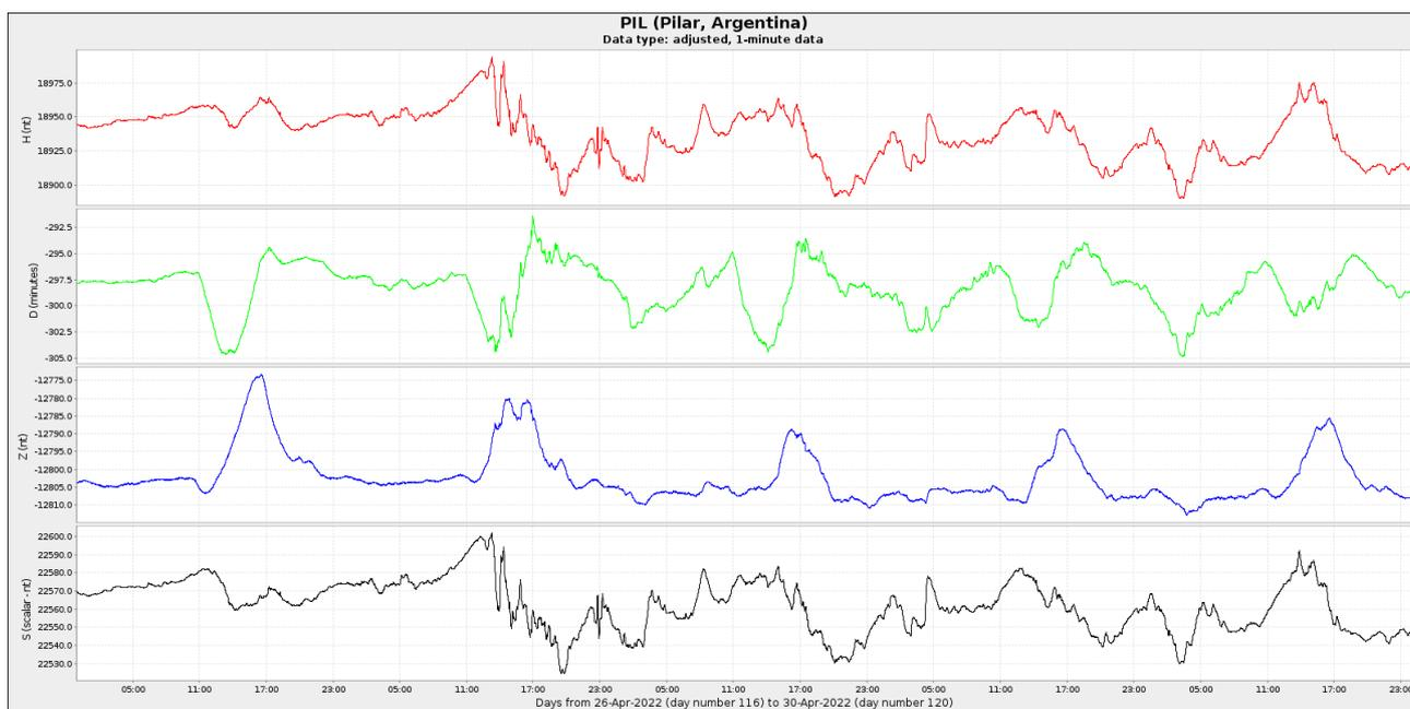
**Figura 4c:** Componentes del campo magnético del 21 al 30 de abril. En rojo se ve la componente horizontal (H) y en azul la vertical (Z), ambas en nT. En verde se presenta la declinación del campo magnético (D) en minutos y en negro la intensidad del campo magnético en nT.
