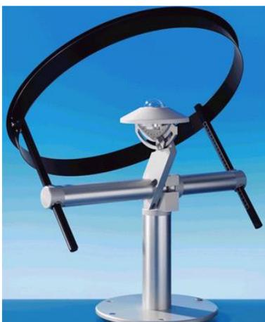
Figura 2. Piranómetros termoeléctricos utilizados por el SMN
