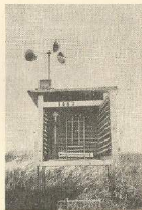
FIG. 5. — Casilla sud. Nótese a la derecha de la misma el evaporímetro de bola de porcelana.
