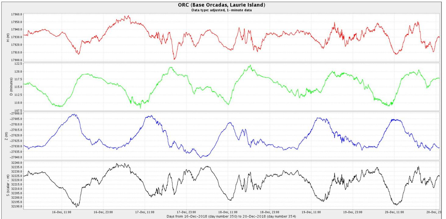
**Figura 4b:** Componentes del campo magnético del 11 al 20 de diciembre. En rojo se ve la componente horizontal ( $H$ ) y en azul la vertical ( $Z$ ), ambas en nT. En verde se presenta la declinación del campo magnético ( $D$ ) en minutos y en negro la intensidad del campo magnético en nT.
