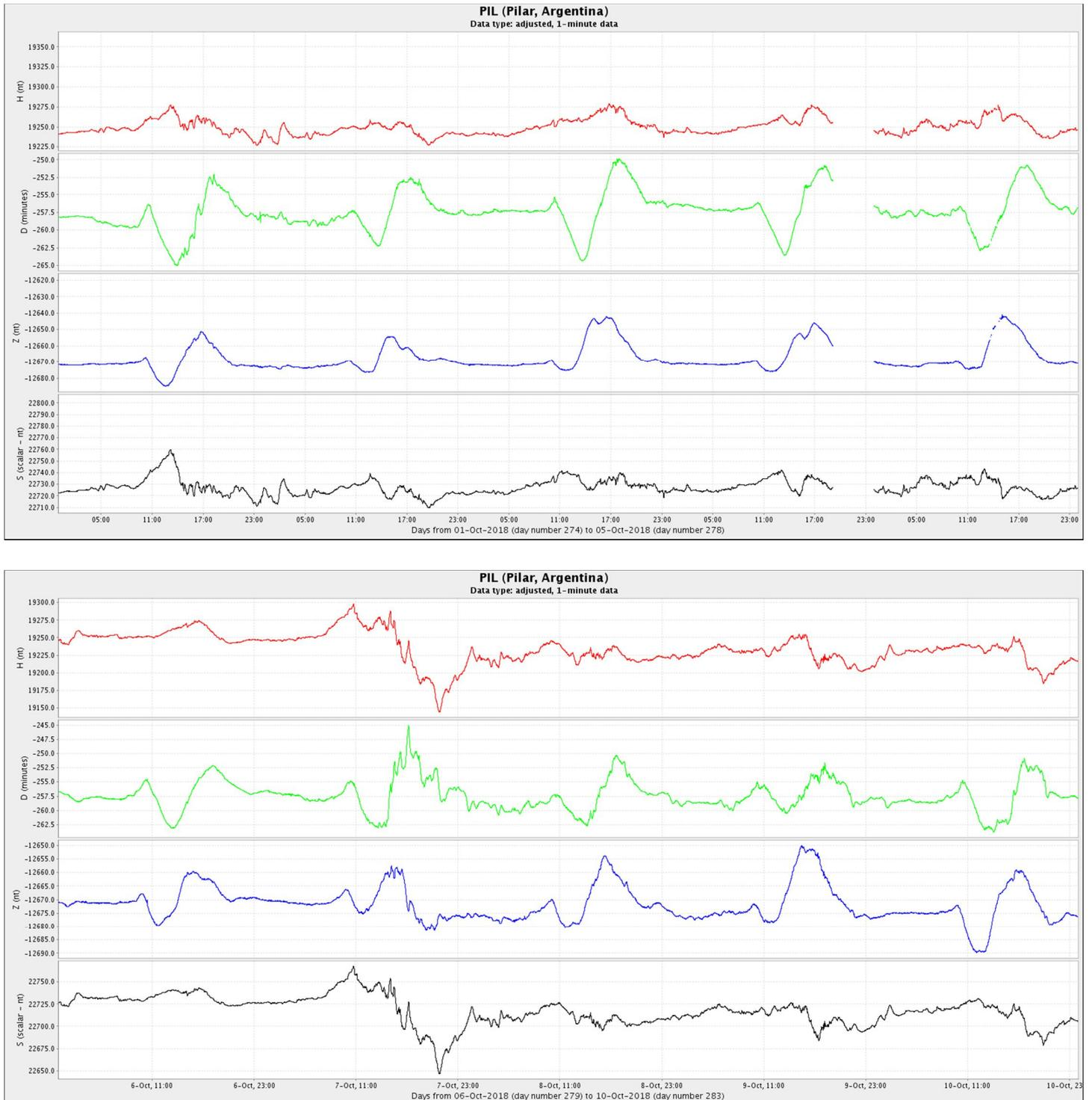
**Figura 4a:** Componentes del campo magnético del 1 al 10 de octubre. En rojo se ve la componente horizontal (H) y en azul la vertical (Z), ambas en nT. En verde se presenta la declinación del campo magnético (D) en minutos y en negro la intensidad del campo magnético en nT
