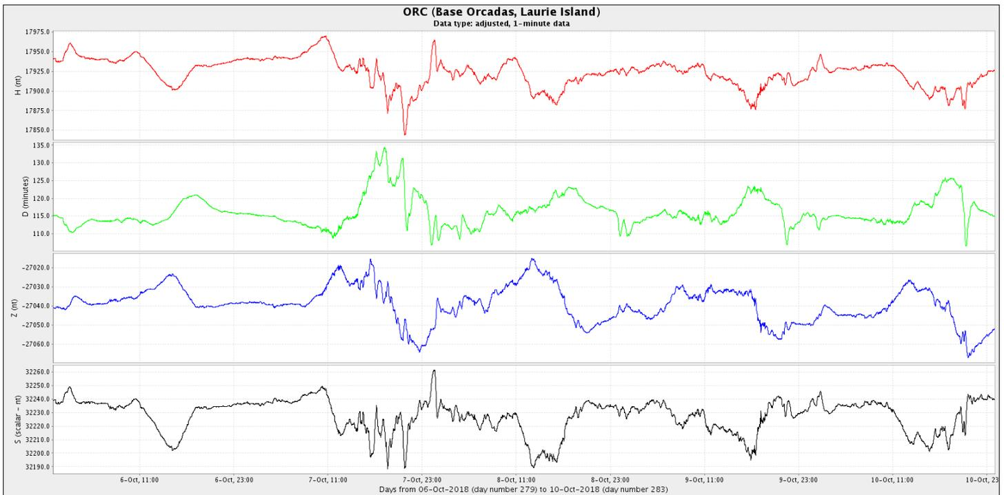
**Figura 4a:** Componentes del campo magnético del 1 al 10 de octubre. En rojo se ve la componente horizontal (H) y en azul la vertical (Z), ambas en nT. En verde se presenta la declinación del campo magnético (D) en minutos y en negro la intensidad del campo magnético en nT
