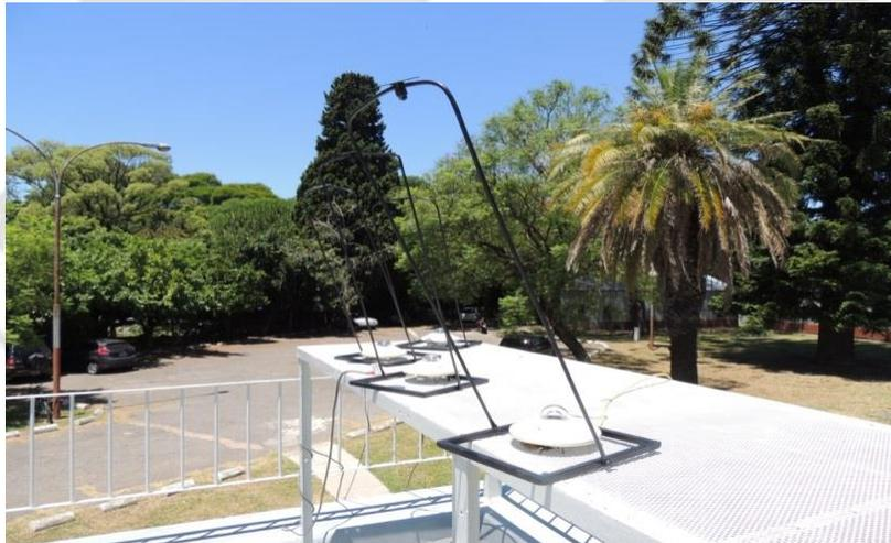
*Figura 2. Proceso de tapado y destapado durante la intercomparación de sensores de radiación solar.*
