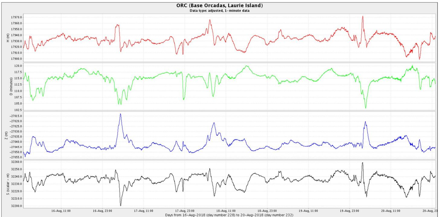
**Figura 4b:** Componentes del campo magnético del 11 al 20 de agosto. En rojo se ve la componente horizontal ( $H$ ) y en azul la vertical ( $Z$ ), ambas en nT. En verde se presenta la declinación del campo magnético ( $D$ ) en minutos y en negro la intensidad del campo magnético en nT.
