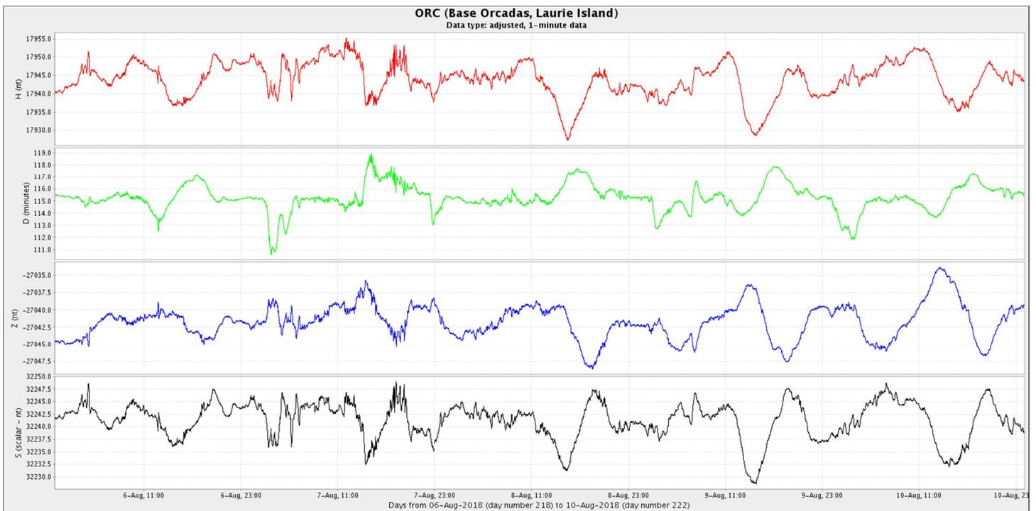
**Figura 4a:** Componentes del campo magnético del 1 al 10 de agosto. En rojo se ve la componente horizontal (H) y en azul la vertical (Z), ambas en nT. En verde se presenta la declinación del campo magnético (D) en minutos y en negro la intensidad del campo magnético en nT
