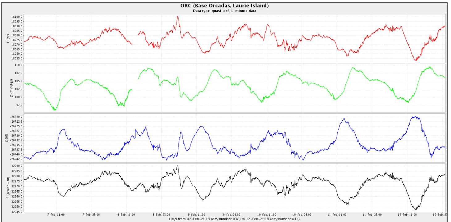
**Figura 4a:** Componentes del campo magnético del 1 al 12 de febrero. En rojo se ve la componente horizontal (H) y en azul la vertical (Z), ambas en nT. En verde se presenta la declinación del campo magnético (D) en minutos y en negro la intensidad del campo magnético en nT
