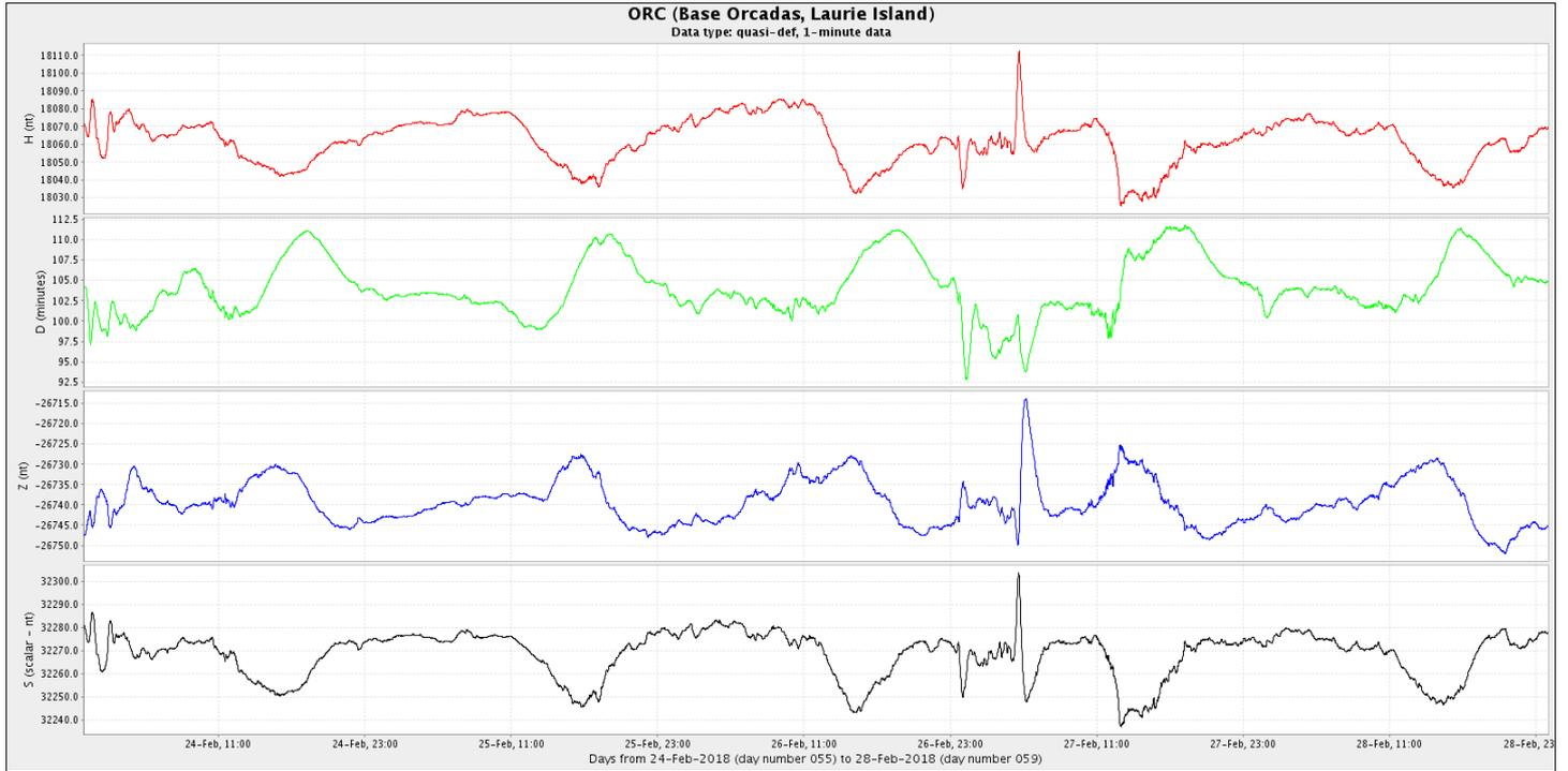
**Figura 4c:** Componentes del campo magnético del 24 al 28 de febrero. En rojo se ve la componente horizontal (H) y en azul la vertical (Z), ambas en nT. En verde se presenta la declinación del campo magnético (D) en minutos y en negro la intensidad del campo magnético en nT.
