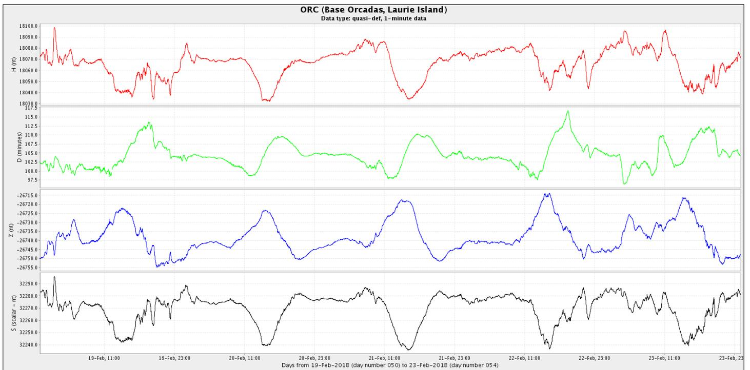
**Figura 4b:** Componentes del campo magnético del 13 al 23 de febrero. En rojo se ve la componente horizontal ( $H$ ) y en azul la vertical ( $Z$ ), ambas en nT. En verde se presenta la declinación del campo magnético ( $D$ ) en minutos y en negro la intensidad del campo magnético en nT.
