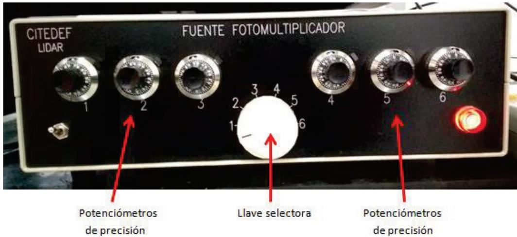
Leer los voltajes en el multímetro. La tensión indicada debe ser un número estable, de no ser así, verificar que el multímetro esté conectado correctamente a la fuente fotomultiplicador.
