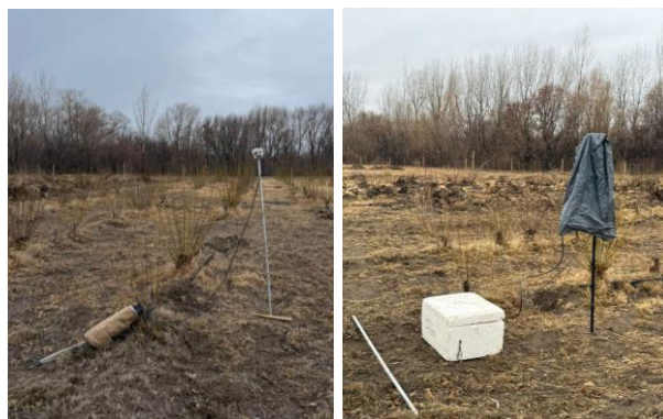
Fig. 9. Registros de F en el punto seleccionado como estación base del terreno. a- Geometrics G857. b- GEM GSM19, cubierto por las lluvias.
