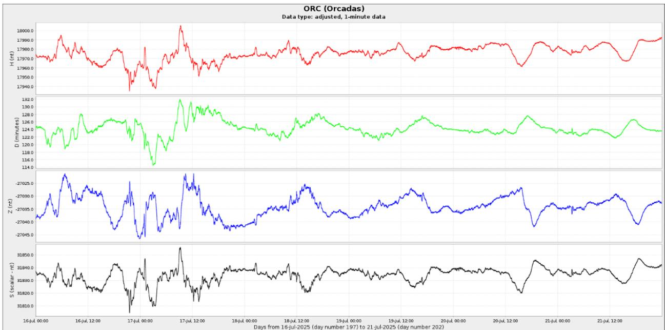
**Figura 4b** Componentes del campo magnético del 11 al 21 de julio. En rojo se ve la componente horizontal (H) y en azul la vertical (Z), ambas en nT. En verde se presenta la declinación del campo magnético (D) en minutos y en negro la intensidad del campo magnético en nT.
