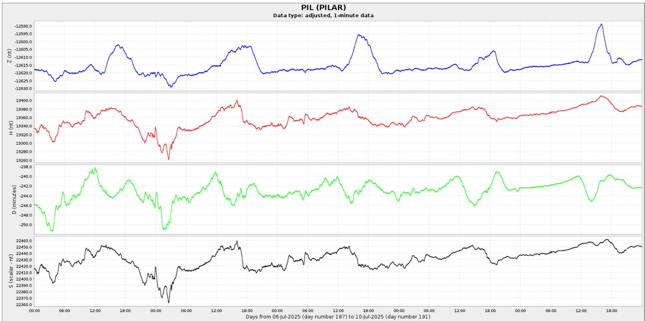
**Figura 4a:** Componentes del campo magnético del día 1 al 10 de julio. En rojo se ve la componente horizontal (H) y en azul la vertical (Z), ambas en nT. En verde se presenta la declinación del campo magnético (D) en minutos y en negro la intensidad del campo magnético en nT.
