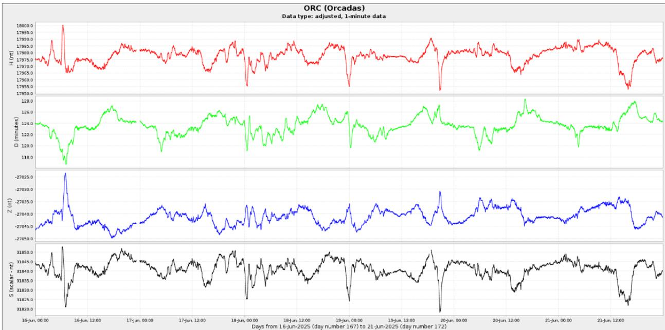
**Figura 4b** Componentes del campo magnético del 11 al 21 de junio. En rojo se ve la componente horizontal (H) y en azul la vertical (Z), ambas en nT. En verde se presenta la declinación del campo magnético (D) en minutos y en negro la intensidad del campo magnético en nT.
