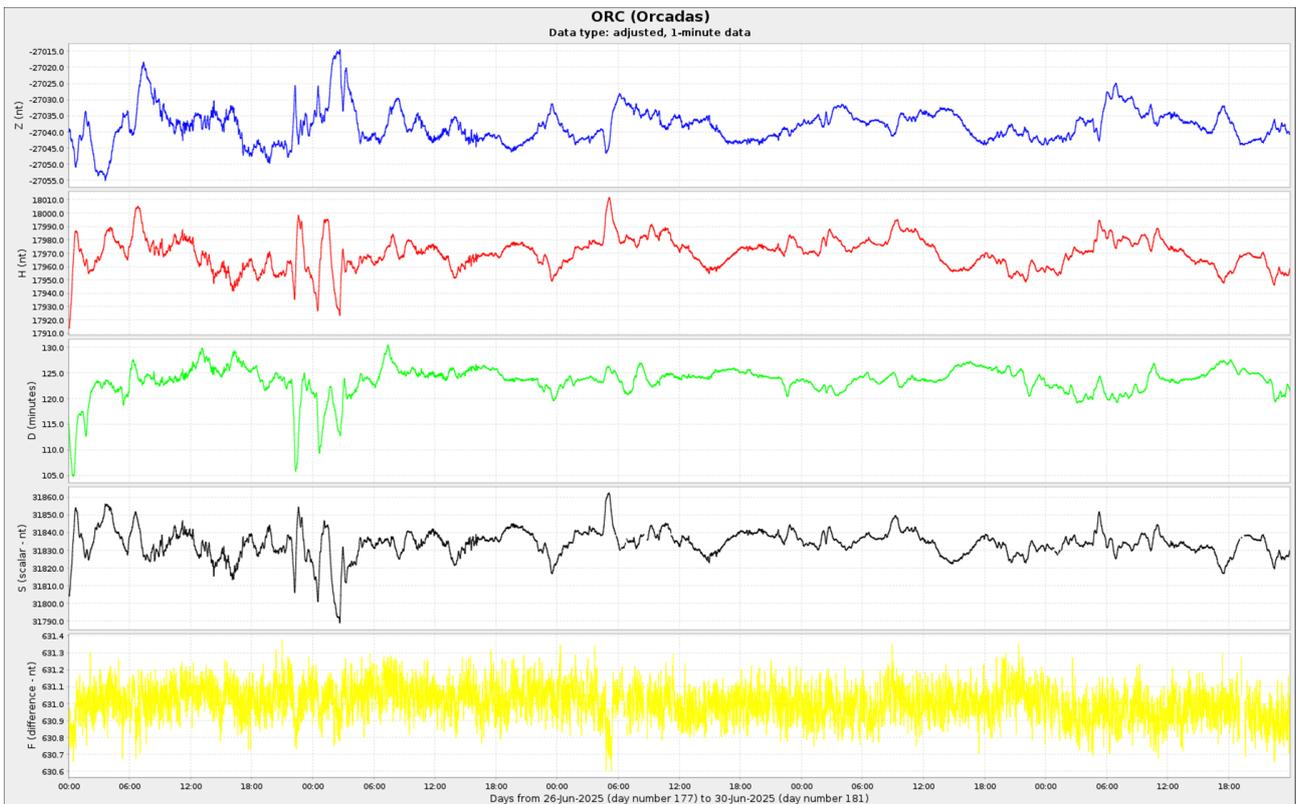
**Figura 4c:** Componentes del campo magnético del 21 al 30 de junio. En rojo se ve la componente horizontal (H) y en azul la vertical (Z), ambas en nT. En verde se presenta la declinación del campo magnético (D) en minutos y en negro la intensidad del campo magnético en Nt, dejando la aclaración la ausencia de datos de la intensidad del campo magnético debido a mantenimiento del sistema indigo.
