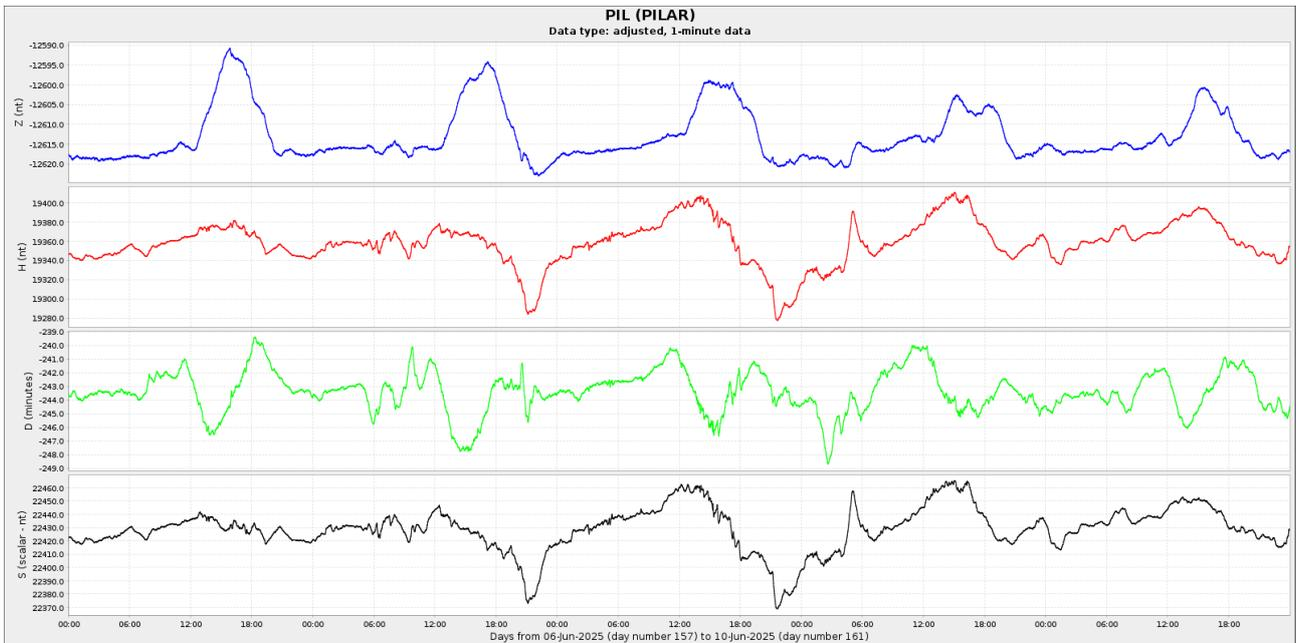
**Figura 4a:** Componentes del campo magnético del día 1 al 10 de junio. En rojo se ve la componente horizontal (H) y en azul la vertical (Z), ambas en nT. En verde se presenta la declinación del campo magnético (D) en minutos y en negro la intensidad del campo magnético en nT.
