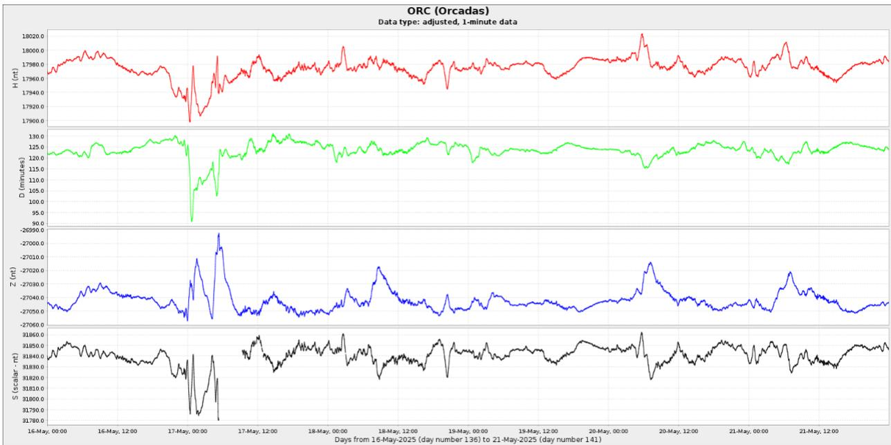
**Figura 4b** Componentes del campo magnético del 11 al 21 de mayo. En rojo se ve la componente horizontal (H) y en azul la vertical (Z), ambas en nT. En verde se presenta la declinación del campo magnético (D) en minutos y en negro la intensidad del campo magnético en nT.
