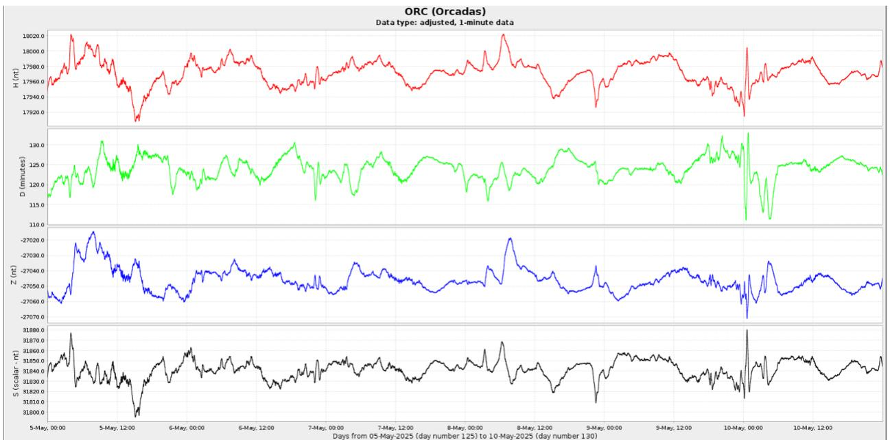
**Figura 4a:** Componentes del campo magnético del 1 al 10 de mayo. En rojo se ve la componente horizontal (H) y en azul la vertical (Z), ambas en nT. En verde se presenta la declinación del campo magnético (D) en minutos y en negro la intensidad del campo magnético en nT
