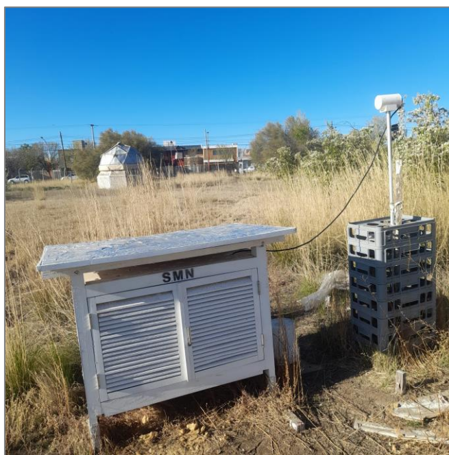
Figura 4: Abrigo Geomagnético de la Estación CIP
