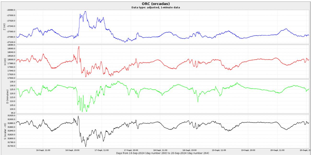
**Figura 4b** Componentes del campo magnético del 11 al 20 de septiembre. En rojo se ve la componente horizontal (H) y en azul la vertical (Z), ambas en nT. En verde se presenta la declinación del campo magnético (D) en minutos y en negro la intensidad del campo magnético en nT.
