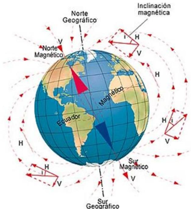
El campo o las líneas de flujo, siguen la trayectoria que muestra la Figura 2. Nótese que la dirección del campo es vertical en los polos magnéticos, y horizontal en el ecuador magnético. El entendimiento de esta geometría es importante para la interpretación de las anomalías magnéticas. La intensidad del campo, es una función de la cantidad de líneas por unidad de área.
