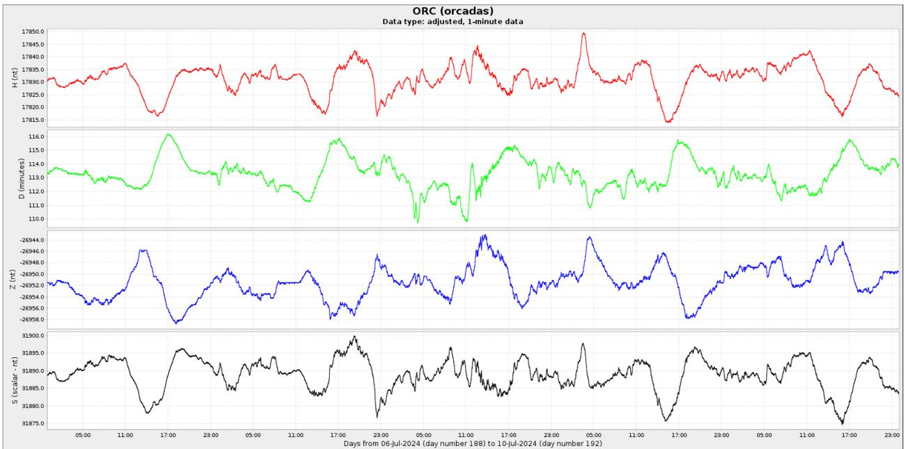
**Figura 4a:** Componentes del campo magnético del 1 al 10 de julio. En rojo se ve la componente horizontal (H) y en azul la vertical (Z), ambas en nT. En verde se presenta la declinación del campo magnético (D) en minutos y en negro la intensidad del campo magnético en nT
