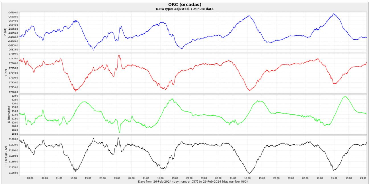
**Figura 4c:** Componentes del campo magnético del 21 al 29 de febrero. En rojo se ve la componente horizontal (H) y en azul la vertical (Z), ambas en nT. En verde se presenta la declinación del campo magnético (D) en minutos y en negro la intensidad del campo magnético en nT.
