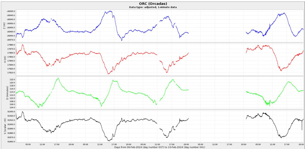
**Figura 4a:** Componentes del campo magnético del 1 al 10 de febrero. En rojo se ve la componente horizontal (H) y en azul la vertical (Z), ambas en nT. En verde se presenta la declinación del campo magnético (D) en minutos y en negro la intensidad del campo magnético en nT
