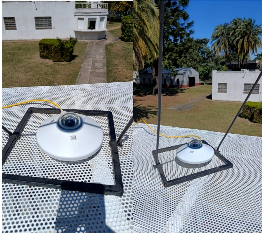
Fig. 1. Momento de “tapado” donde se observa la sombra proyectada por el elemento externo sobre el piranómetro a ser calibrado.
