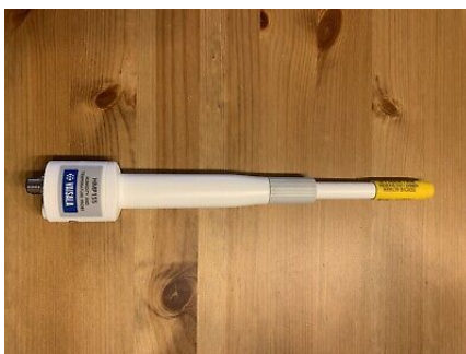
Figura 2: Sensor de temperatura y humedad o termohigrómetro HMP155 Vaisala
