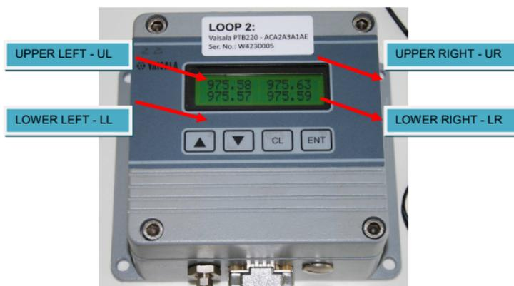
**Figura 5:** Panel visualizador del sensor de presión PTB220.
