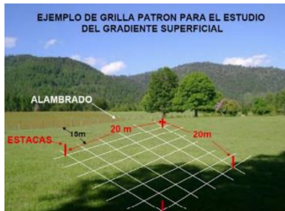
Fig. 2: Ejemplo de grilla. El tamaño superficial y de equidistancia de esta grilla es el correspondiente para determinar la posición en que debe instalarse un instrumento.
