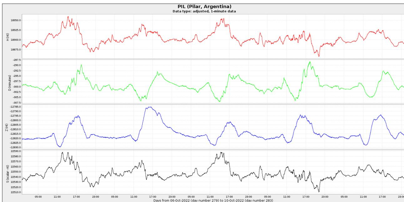
**Figura 4a:** Componentes del campo magnético del día 1 al 10 de octubre. En rojo se ve la componente horizontal (H) y en azul la vertical (Z), ambas en nT. En verde se presenta la declinación del campo magnético (D) en minutos y en negro la intensidad del campo magnético en nT
