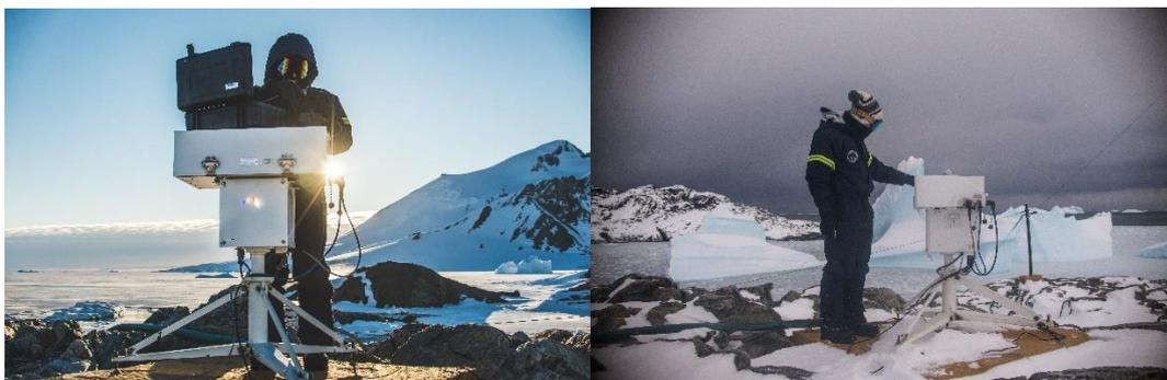
*Test de lámpara y mantenimiento diario del espectrofotómetro Brewer de Base San Martín por el personal técnico del IAA Ezequiel Peschiera y Nahuel Solís Etchegoin (2020).*
