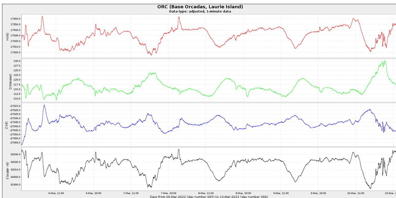
**Figura 4a:** Componentes del campo magnético del 1 al 10 de marzo. En rojo se ve la componente horizontal (H) y en azul la vertical (Z), ambas en nT. En verde se presenta la declinación del campo magnético (D) en minutos y en negro la intensidad del campo magnético en nT
