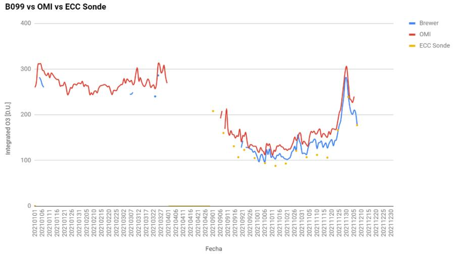
En la imagen podemos ver los registros del espectrofotómetro Brewer #099 (año 2021) vs registro satelital de OMI y algunas valores de las ozonsondas lanzadas durante el presente año.
