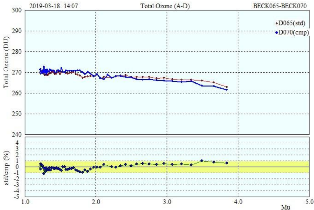
Fig. 3: Cantidad de TO3 del instrumento de referencia vs. el D070 y error % entre ambos luego de la segunda comparación.
