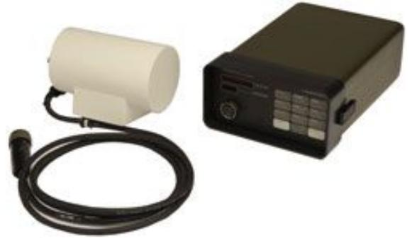
*Figura 3: Magnetómetro de Precesión Protónica,
