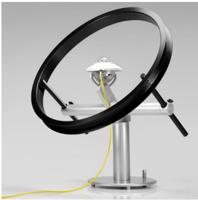
Figura 2. Aro sombreador que proyecta sombra sobre el sensor para medira radiación difusa. Fuente https://www.kippzonen.com/
