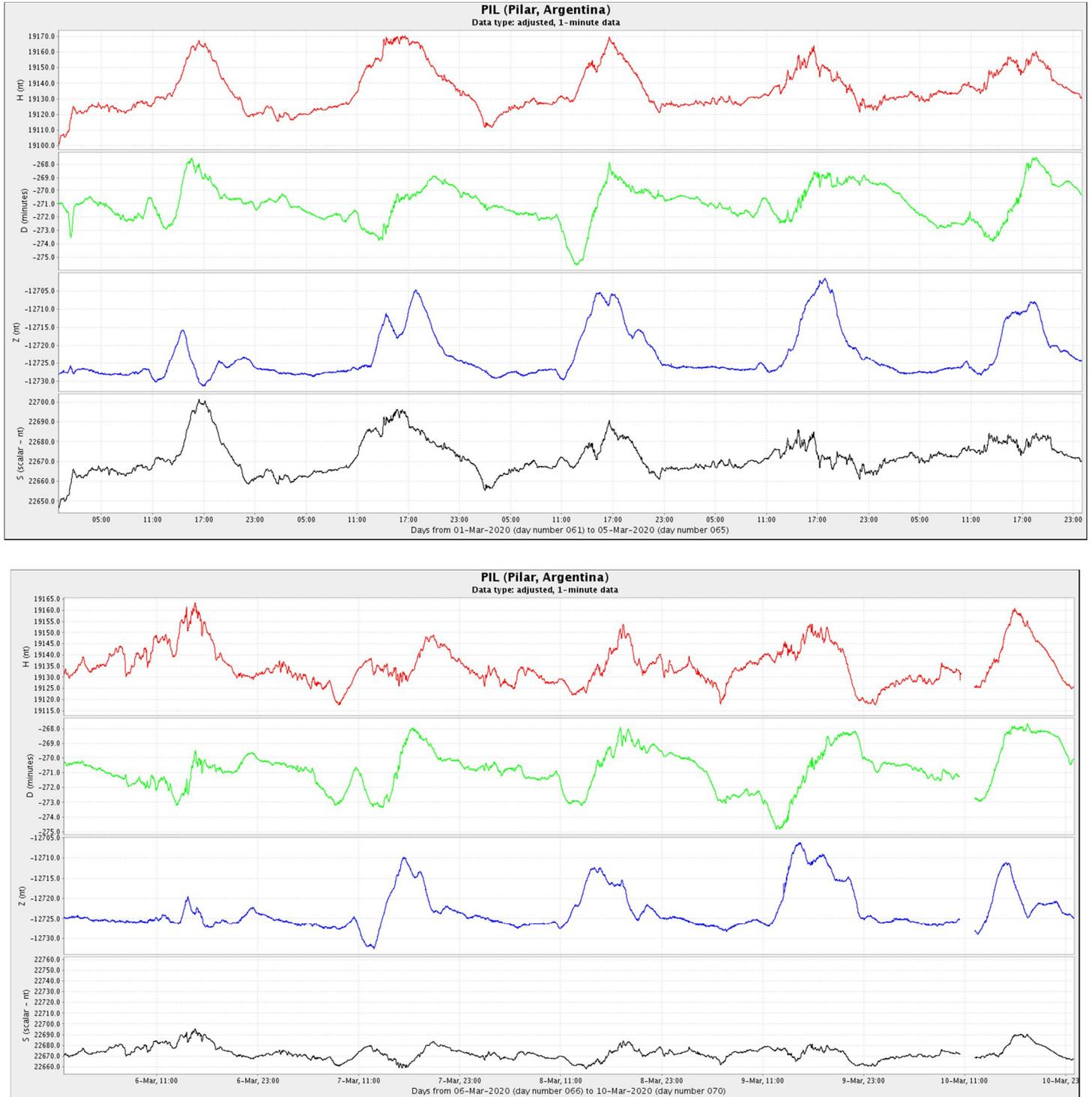
Figura 4a: Componentes del campo magnético del día 1al 10 de marzo. En rojo se ve la componente horizontal (H) y en azul la vertical (Z), ambas en nT. En verde se presenta la declinación del campo magnético (D) en minutos y en negro la intensidad del campo magnético en nT
