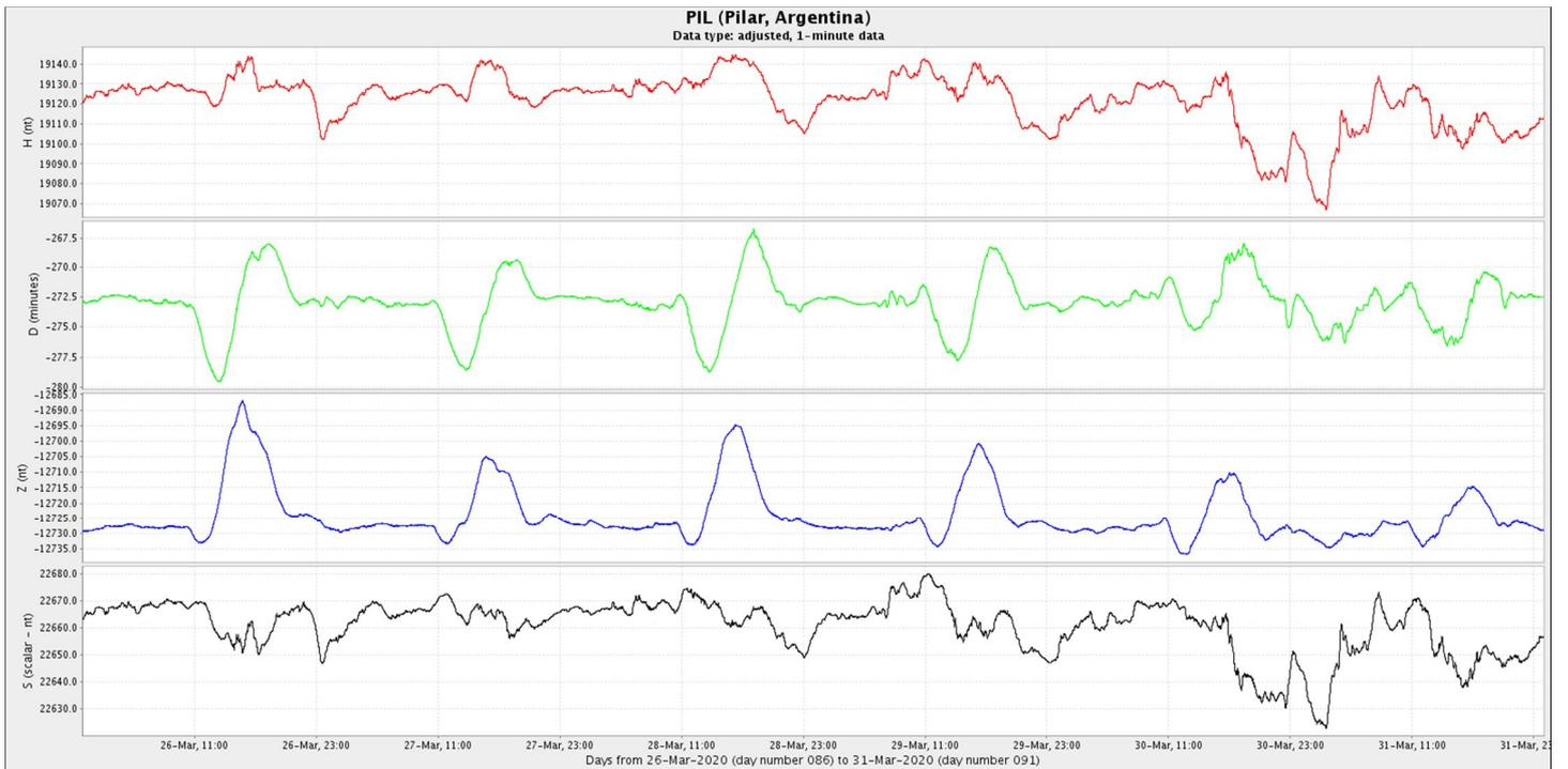
**Figura 4c:** Componentes del campo magnético del 21 al 31 de marzo. En rojo se ve la componente horizontal (H) y en azul la vertical (Z), ambas en nT. En verde se presenta la declinación del campo magnético (D) en minutos y en negro la intensidad del campo magnético en nT.
