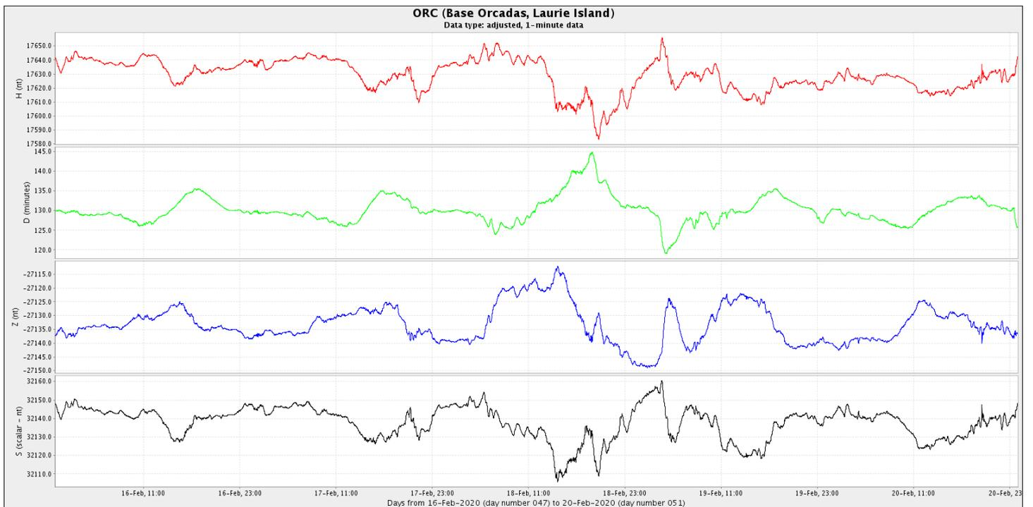
**Figura 4b** Componentes del campo magnético del 11 al 20 de febrero. En rojo se ve la componente horizontal (H) y en azul la vertical (Z), ambas en nT. En verde se presenta la declinación del campo magnético (D) en minutos y en negro la intensidad del campo magnético en nT
