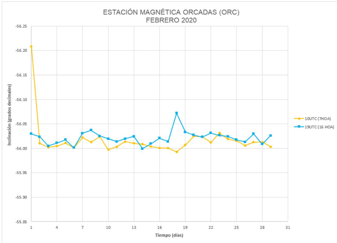
Figura 6: Inclinación magnética en función del tiempo
