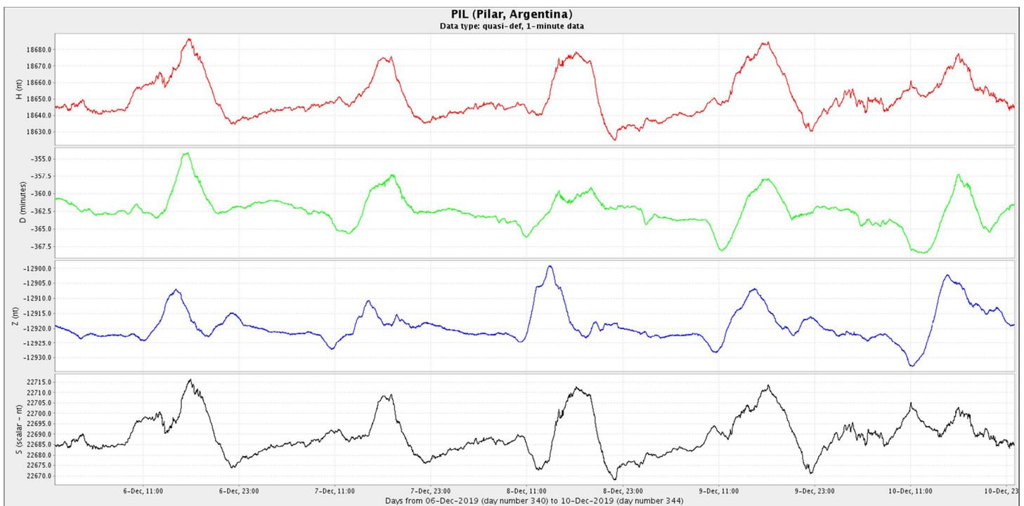
**Figura 4a:** Componentes del campo magnético del día 1al 10 de diciembre. En rojo se ve la componente horizontal (H) y en azul la vertical (Z), ambas en nT. En verde se presenta la declinación del campo magnético (D) en minutos y en negro la intensidad del campo magnético en nT
