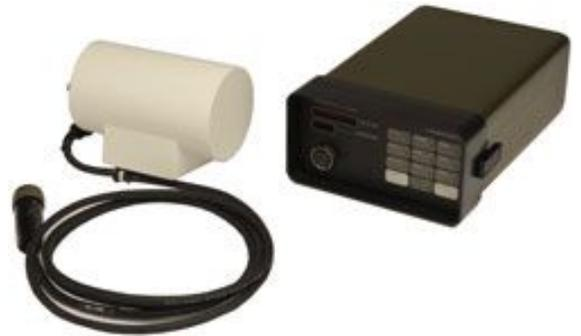
*Figura 3: Magnetómetro de Precesión Protónica,
