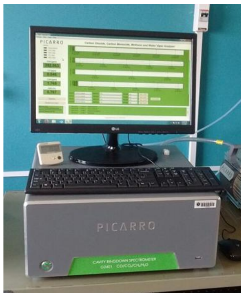
Figura 8. Analizador continuo de gases (monóxido de carbono, dióxido de carbono, metano y vapor de agua) Picarro G2401 de la estación VAG Ushuaia.
