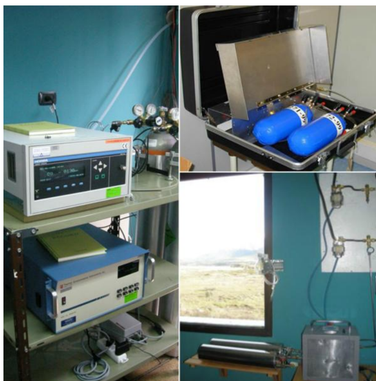
Figura 7. Medición de gases en la estación VAG Ushuaia. Mediciones continuas de monóxido de carbono y ozono superficial con los analizadores Horiba APMA 360 y Thermo 49 C respectivamente (izq.). Mediciones discontinuas con Flask (der.)
