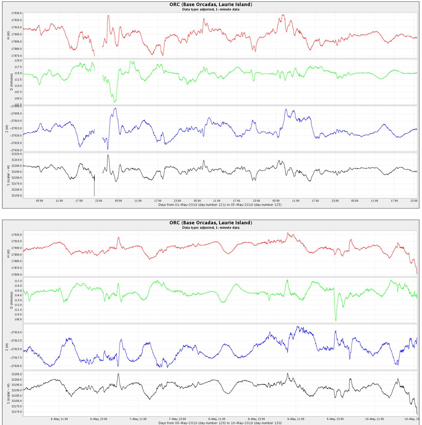
**Figura 4a:** Componentes del campo magnético del 1 al 10 de mayo. En rojo se ve la componente horizontal ( $H$ ) y en azul la vertical ( $Z$ ), ambas en nT. En verde se presenta la declinación del campo magnético ( $D$ ) en minutos y en negro la intensidad del campo magnético en nT
