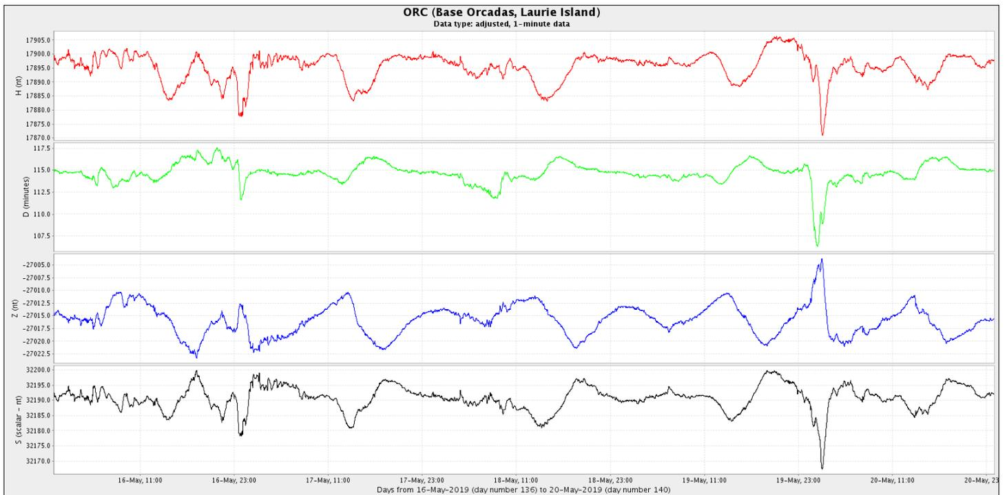
**Figura 4b:** Componentes del campo magnético del 11 al 20 de mayo. En rojo se ve la componente horizontal ( $H$ ) y en azul la vertical ( $Z$ ), ambas en nT. En verde se presenta la declinación del campo magnético ( $D$ ) en minutos y en negro la intensidad del campo magnético en nT.
