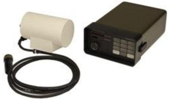
*Figura 3: Magnetómetro de Precesión Protónica,
